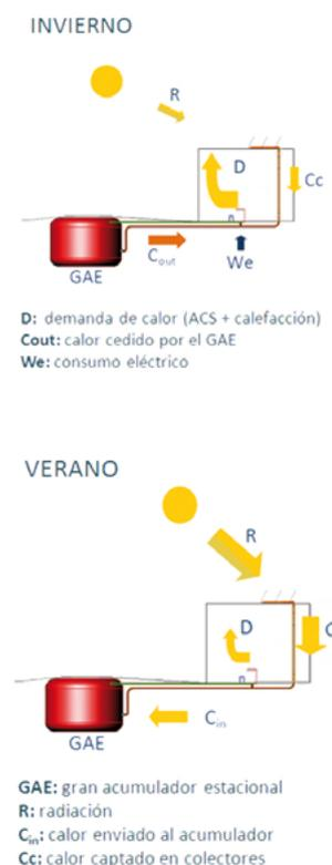
Fig. 1. Sistema de Climatización y Agua Caliente Sanitaria (SCACS) con energía solar.
